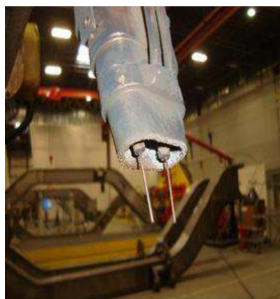
Рис. 2. Рабочая часть горелки тандем и схема процесса
