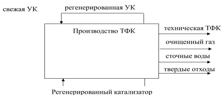
Рисунок 3 - Блок-схема производства технической терефталевой кислоты
